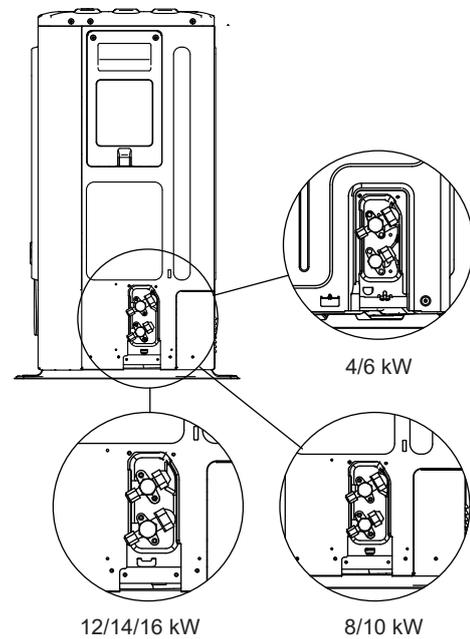
Bitte entfernen Sie die Hohlplatte nach dem Einbau.
