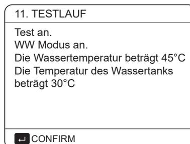
Während des Testlaufs des WW-MODUS beträgt die voreingestellte Solltemperatur des Brauchwassers 55°C. Der TBH (Tank-Boost-Heizung) schaltet sich ein, nachdem der Verdichter 10 Minuten lang gelaufen ist. Der TBH schaltet sich 3 Minuten später aus, die Wärmepumpe arbeitet, bis die Wassertemperatur auf einen bestimmten Wert steigt oder der nächste Befehl empfangen wird.
