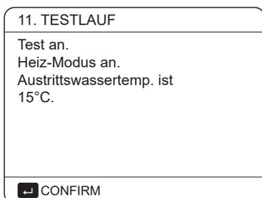
Während des Testlaufs des HEIZMODUS beträgt die voreingestellte Soll-Wassertemperatur am Ausgang 35°C. Die IBH (interne Zusatzheizung) schaltet sich ein, nachdem der Verdichter 10 Minuten lang gelaufen ist. Nachdem der IBH 3 Minuten lang läuft, schaltet sich der IBH aus, die Wärmepumpe arbeitet, bis die Wassertemperatur auf einen bestimmten Wert ansteigt oder der nächste Befehl empfangen wird.
