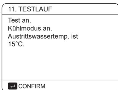
Während des KÜHLMODUS Testlaufs beträgt die voreingestellte Soll-Wassertemperatur am Ausgang 7°C. Das Gerät arbeitet so lange, bis die Wassertemperatur auf einen bestimmten Wert fällt oder der nächste Befehl empfangen wird.
