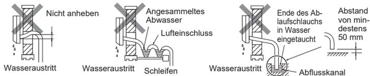
Führen Sie das Abflussrohr nicht direkt in einen Abflusskanal, in dem Ammoniak und schwefelsaure Gase entstehen können. Das sich verflüchtigende ätzende Gas kann durch das Abflussrohr zum Innenraum zurückströmen, was zu unangenehmen Gerüchen und Korrosion am Wärmetauscher führen kann.
