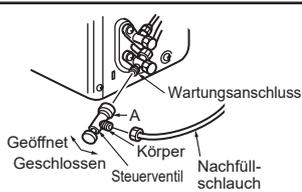
Beim Anbringen des Steuerventils an dem Wartungsanschluss kann sich der Ventileinsatz verformen oder lockern, wenn ein übermäßiger Druck ausgeübt wird. Dadurch kann ein Gasleck verursacht werden.
