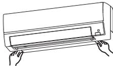
\* Beim Installieren/Entfernen oder Transportieren der Blende nicht Teil A halten, da dies die Blende beschädigen könnte.
