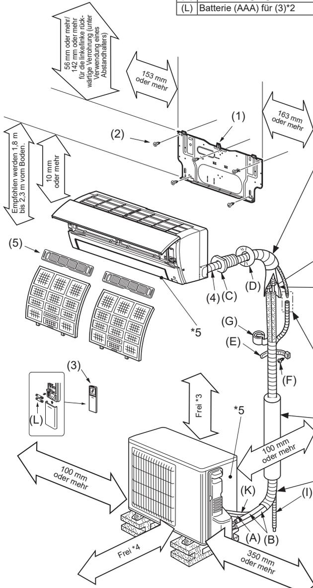
Verwenden Sie unbedingt die Wanddurchbruchhülse (C), um einen Kontakt des Innen-/Außengerät-Verbindungskabels (A) mit Metallteilen in der Wand sowie Beschädigungen durch Ratten bei Hohlwänden zu verhindern.
