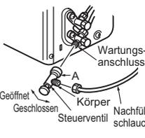
Beim Anbringen des Steuerventils an dem Wartungsanschluss kann sich der Ventileinsatz verformen oder lockern, wenn ein übermäßiger Druck ausgeübt wird. Dadurch kann ein Gasleck verursacht werden.
