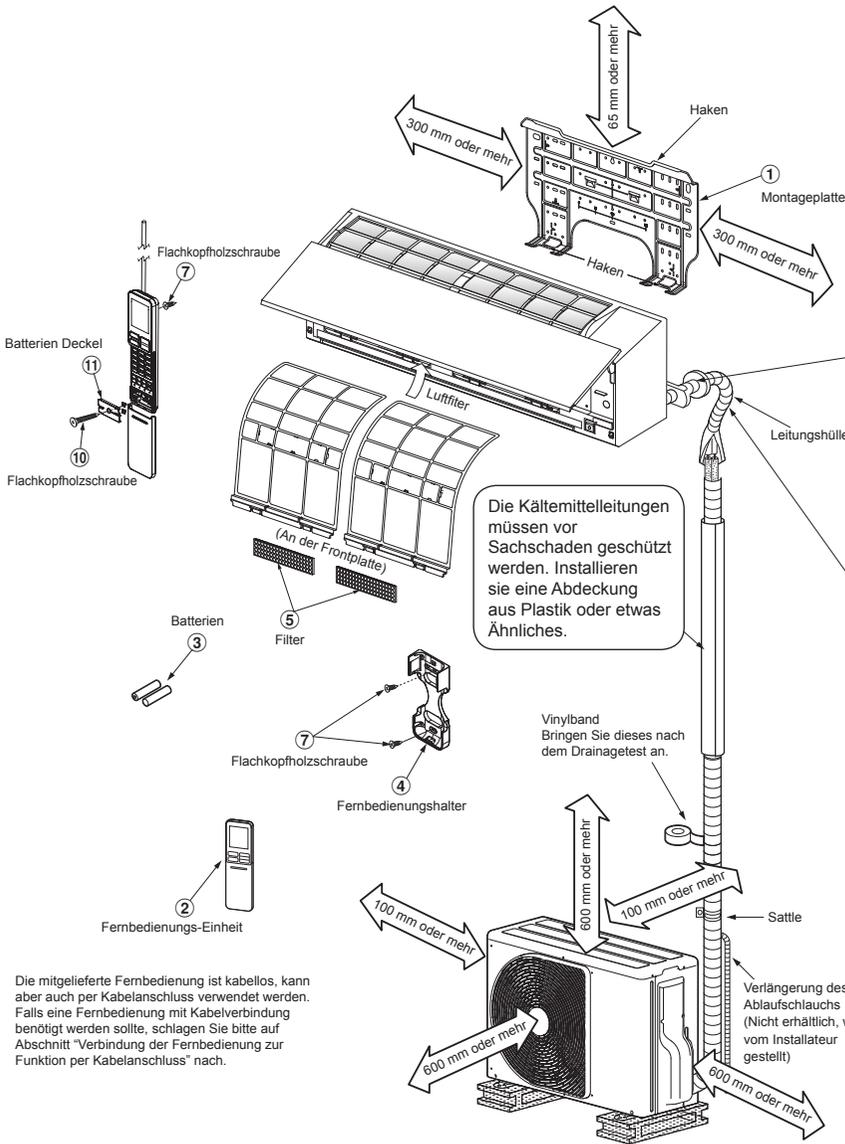
Die mitgelieferte Fernbedienung ist kabellos, kann aber auch per Kabelanschluss verwendet werden. Falls eine Fernbedienung mit Kabelverbindung benötigt werden sollte, schlagen Sie bitte auf Abschnitt "Verbindung der Fernbedienung zur Funktion per Kabelanschluss" nach.
