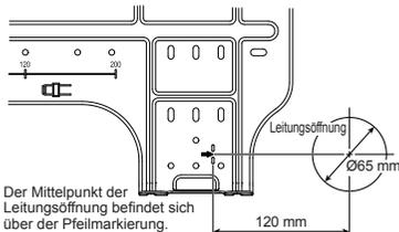
1. Nach dem die Position des Durchbruches mit Hilfe der Montageplatte (➔) bestimmt wurde, ist die Bohrung (Ø65 mm) mit leichtem Gefälle nach außen anzulegen.
