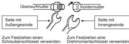
Zum Festziehen einen Schraubenschlüssel verwenden. Zum Festziehen eine Drehmomentschlüssel verwenden.
